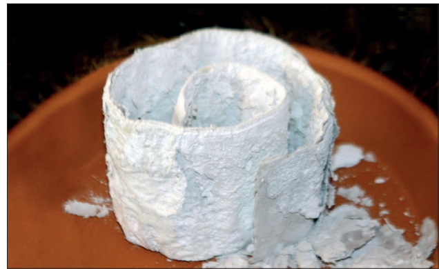
Fig. 12 Corrosió d'una làmina de plom d'on prové el color blanc anomenat blanc de plom.
