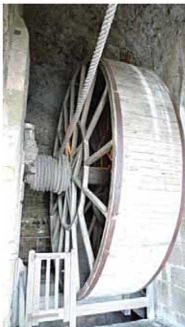
Foto 7. Vista de roda utilitzada en l'abadia del Mont Sant-Michel (França) per a l'elevació d'aliments.
