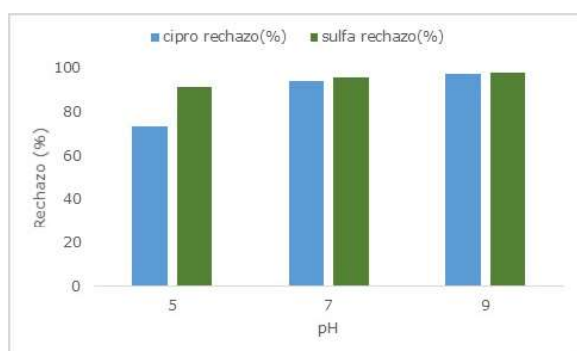
Figura 6. Separación de CIPRO / SULFA mediante NF a diferentes valores de pH. Presión= 10 Bar
