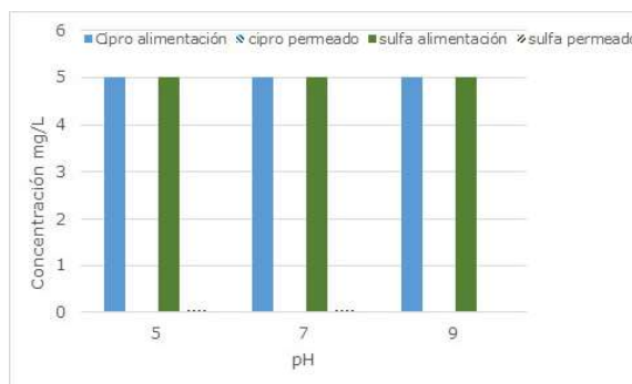
Figura 8. Separación de la mezcla CIPRO/SULFA mediante OI a diferentes valores de pH. Presión= 15 Bar
