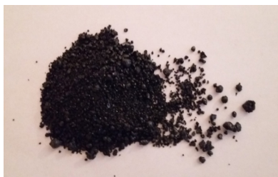
Figura 1. Silicat de ferro obtingut de la escoria metalúrgica produïda en el Horno Eléctrico del proceso de obtención del cobre electrolítico.
