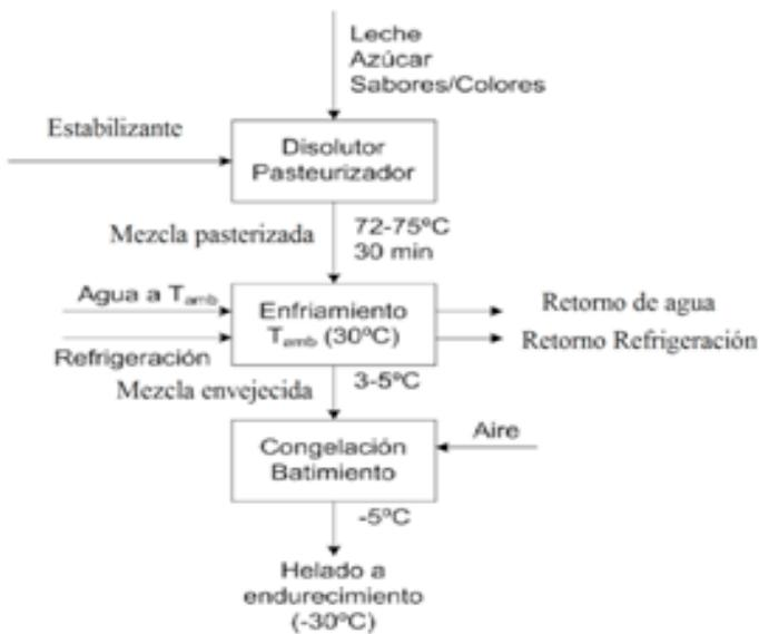
**Figura 2:** Esquema del proceso empleado para la producción de helados a escala piloto.
