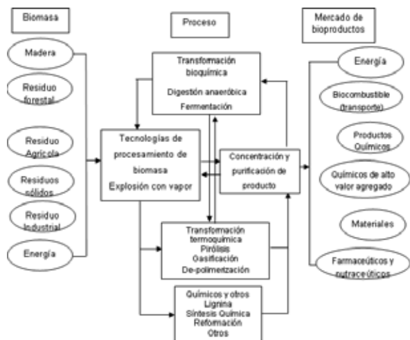
Figura 2. Posibilidades de materia prima, procesos y productos en la Biorrefinería.
