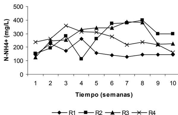
Fig.4. Variación de la concentración de N-NH<sub>4</sub><sup>+</sup> en los lixiviados de los 4 reactores
