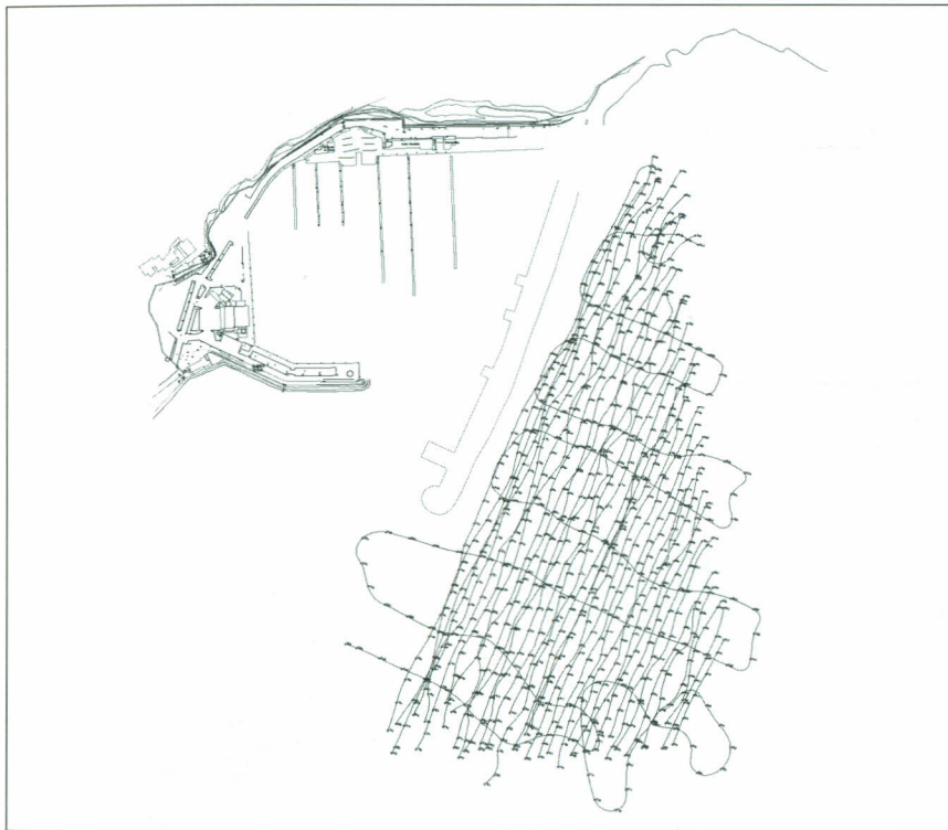
Fig. 10. Recorreguts reals (transectes) de l'embarcació amb l'ecosonda paramètrica i remolcant el sensor del magnetòmetre de protons.
