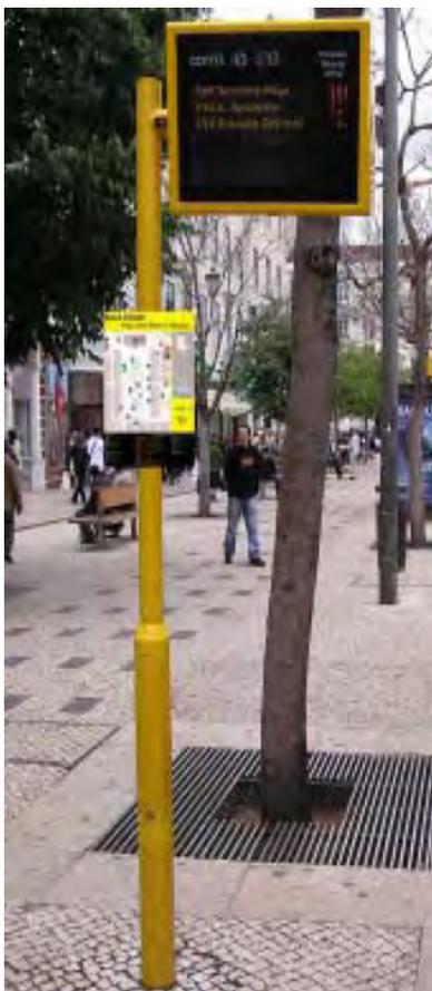
**Proposta A:** Baseia-se na colocação de uma placa de 29,7 cm x 42 cm (tamanho A3). A utilização de vinil autocolante permite que o conteúdo da informação e gráficos se possam actualizar e substituir. A placa é apoiada por braçadeiras anilhadas ao poste em alumínio.
