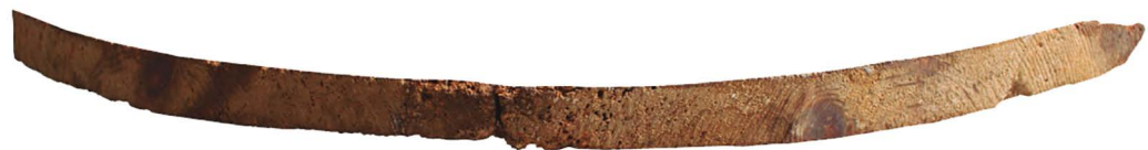
Curvatura còncaua uniforme després de reacoblar les taules.
