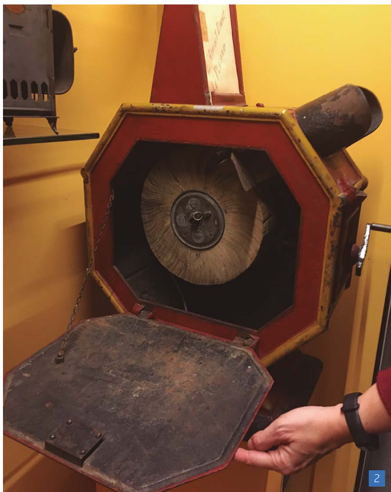
[2] Model de mutoscopi de la companyia International Mutoscope Reel Co. (Fotografia: Ariadna Olivé).
