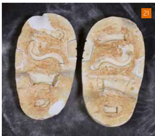
[21] Tipologia de motlle per pressió. Consta de dues caixes mare que, a la vegada, generen el negatiu a reproduir (Fotografia: Jordi Erra).
