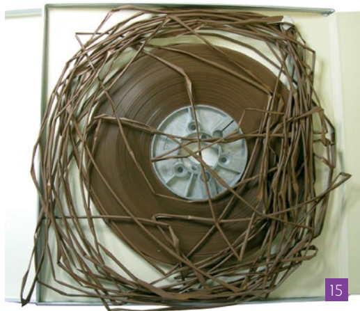
[15] Cinta d'acetat amb les vores corbades per un emmagatzematge poc acurat (Fotografia: BC. SEPIC).
