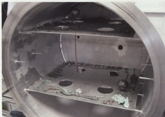
10. Peces arqueològiques de metall a l'interior del reactor de plasma. Laboratori de l'Institut Químic de Sarrià (Fotografia: MHCB).
