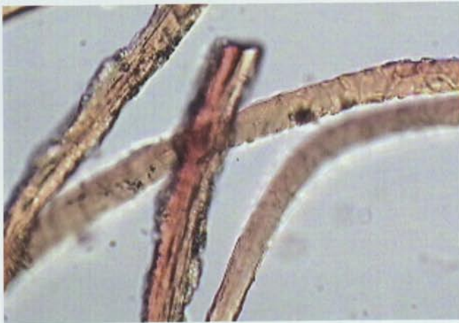
12. Fibres de las zones vellutades de la peça 2 (Núm. reg.: DG / 3 / 03 / 0364) caracteritzades com a llana, amb degradacions que afecten a la queratina (Fotografia: ESCRBC).
