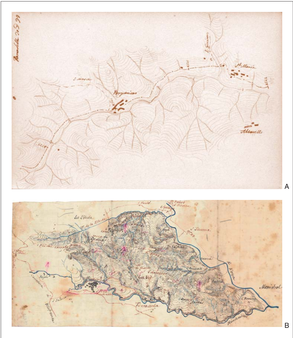
Fig. 3. Dues mostres del treball topogràfic de Brossa. A, minuta de camp dibuixada a una escala aproximada 1:18.000; B, esborrany fragmentari dibuixat a 1:40.000.
