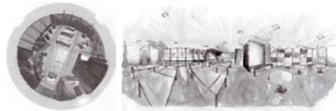
Figura 7: Boceto esférico (RVDi) | Boceto cilíndrico (RVD) (Bussière-Bonnet).
