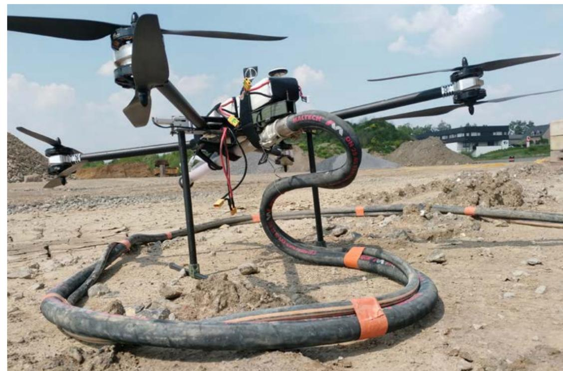
Fig. 10. Manguera del pulverizador de mortero grueso conectada al dron para disponer de suministro de material constante.
