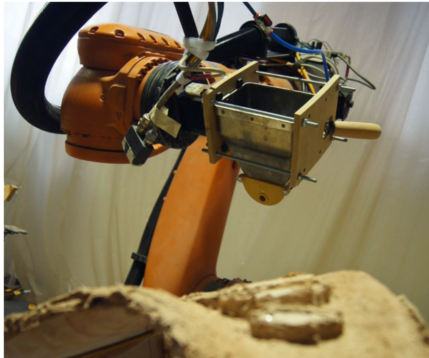
↑ Fig. 3. Polvoritzador manual de morter tradicional acoblat al braç robotitzat Kuka. Angle mitjà respecte de la superfície, 45°. ← Fig. 4. Braç robotitzat Kuka amb sis graus de llibertat de moviment i 100 kg de capacitat de càrrega aplicant la barreja d'argila inicial.
