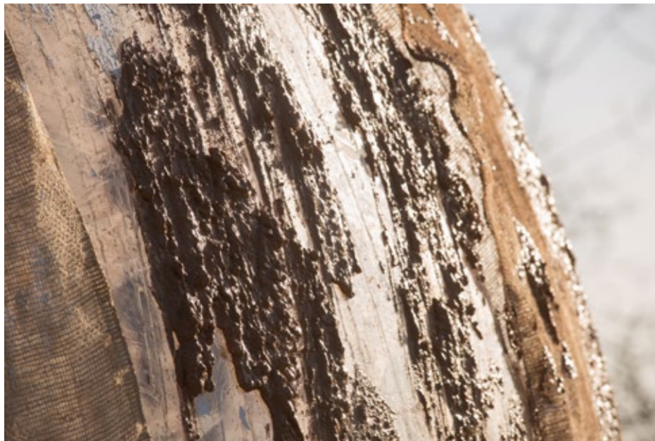
Fig. 9. Ampliació de les capes viscoses intermèdies que el dron projecta sobre la superfície.
