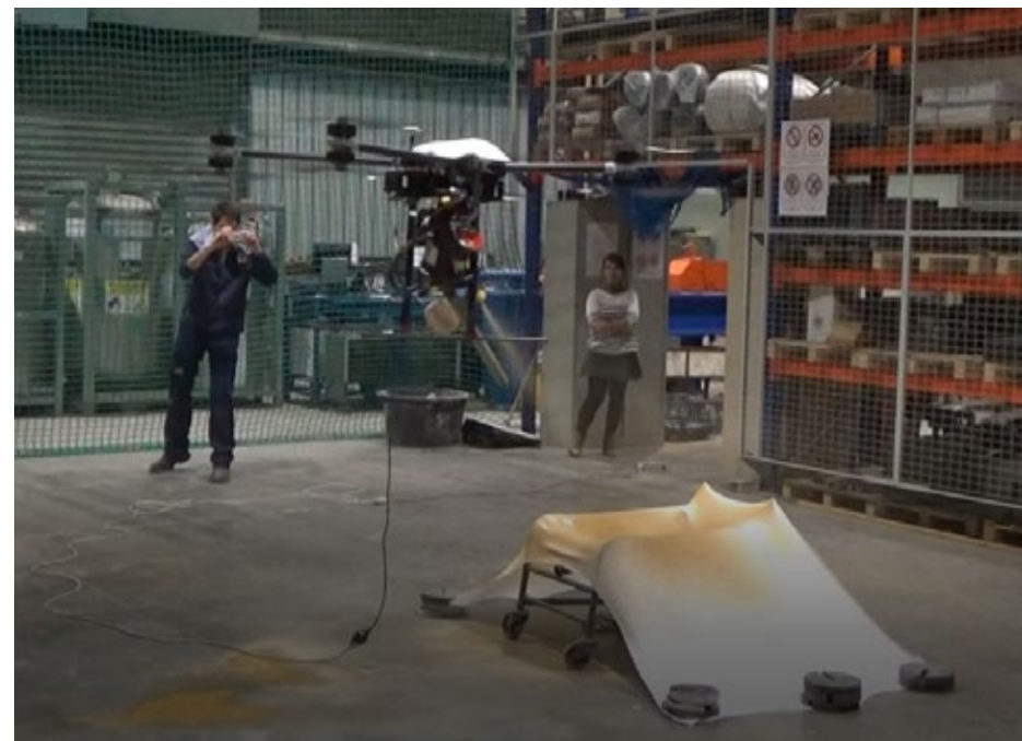
↑ Taula 1. CS1: paràmetres d'aportació de matèria. ← Fig. 5. El dron duu acoblats dos tipus de dispositius polvoritzadors a la part inferior. Esquerra: projecta una barreja líquida d'argila. Dreta: projecta una barreja seca de sorra i fibres. ↙ Fig. 6. Dron realitzant l'aportació de barreja d'argila amb un alt percentatge de guix per formar la segona crosta.
