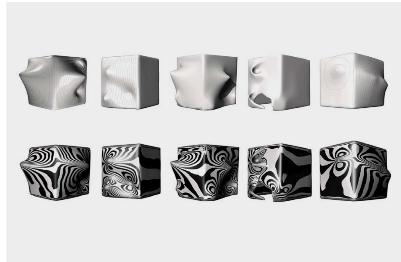
Fig. 5. Imágenes que muestran análisis de curvatura en superficies blandas utilizando diagnóstico zebra striping en Rhino3D
