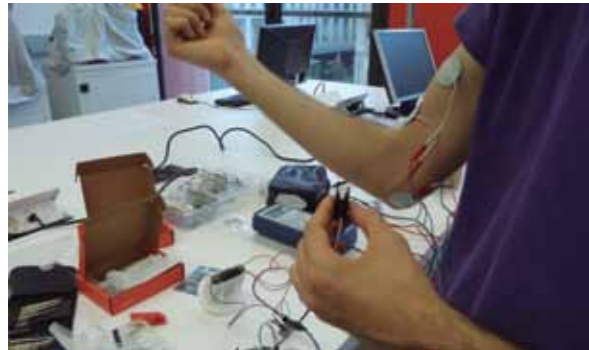
▼ Figura 16. Control del motor servo que genera el moviment d'un dit a partir dels senyals electromiogràfics produïts en la contracció i en la relaxació d'un múscul.
