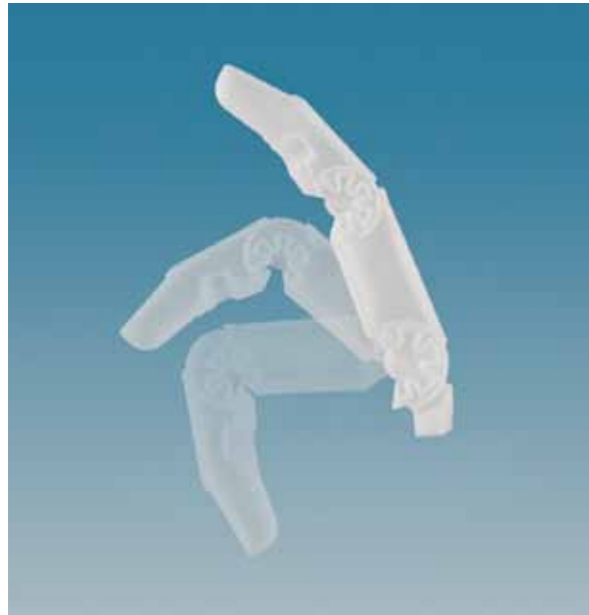
▲ Figura 15. Secció d'un dit en què es mostra el disseny de les articulacions, fabricat en una sola peça gràcies a la fabricació additiva per sinteritzat làser. Fotografia proporcionada per kiwibravo.
