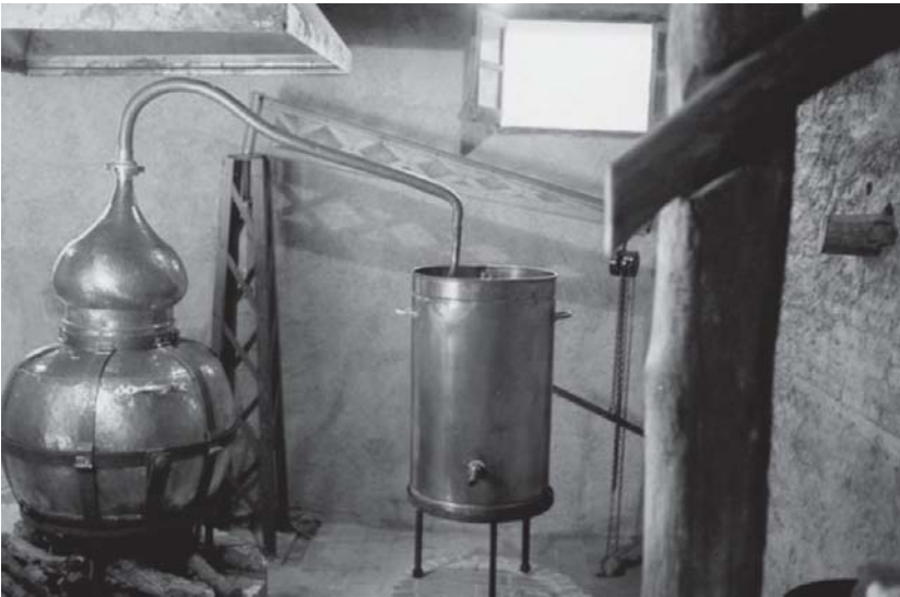
Alambí procedent de Prat de Comte (Terra Alta). Es pot distingir la caldera, el coll i el condensador. Arxiu: www.lollaut.com / Aiguardenter
