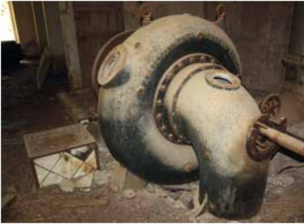
Turbina Singrun Epinal, amb canonada forçada i canonada de descàrrega, dos pernys per hissar, volant d'inèrcia al darrera i base del regulador de velocitat i base de l'alternador.
