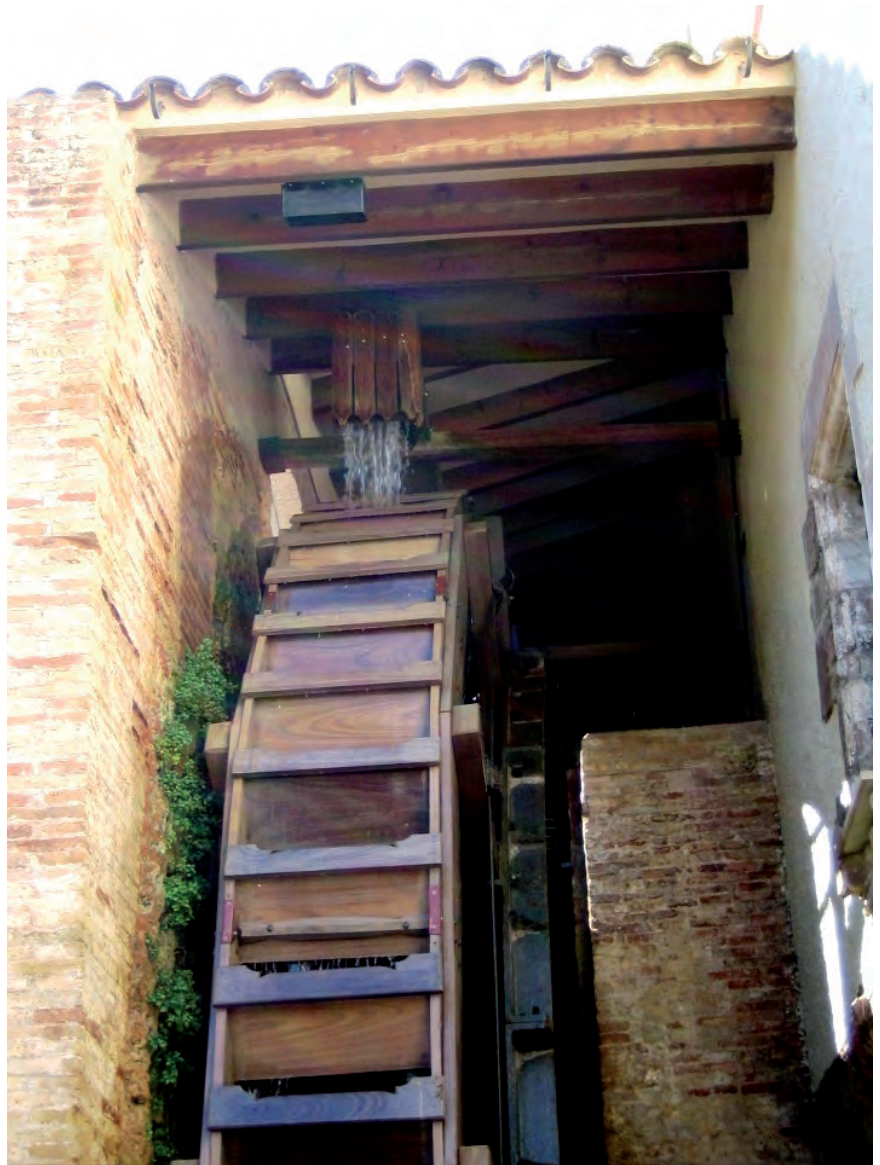
■ Roda de calaixos del Molí de Can Batlle de Vallirana, amb orígens al segle XIII.
