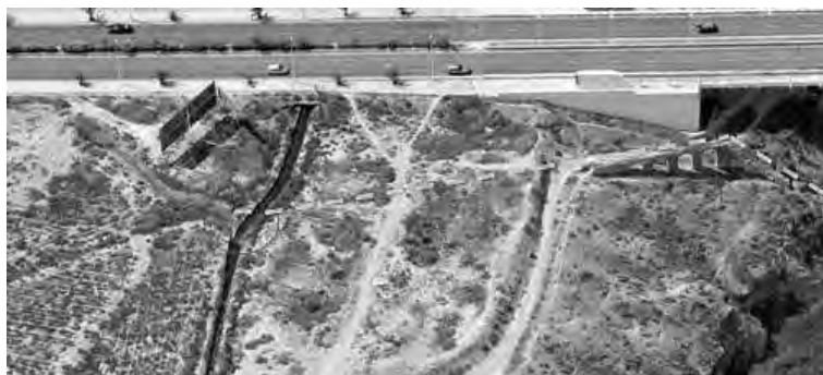
Fig. 5. Presa d'aigua en el Braçal d'Asnell i conducció soterrada (Asnell-Antisequía) a l'aqüeducte en el vessant de llevant del riu del Vinalopó, (orientació al sud). Composició sobre la imatge aèria del 2011. Ref.: http://www.goolzoom.com .
