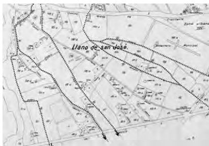
Fig. 8. Estimació dels traçats, i punt on les canalitzacions travessen a la carretera de l'Alt de les Talaies a Múrcia, prenent com a base les referències del plànol cadastral de 1947.
