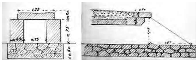
Fig. 12 i 13. Detalls del Plano de la Tagea n° 5 , de la Memoria Descriptiva para el paso del canal principal per la carretera , Alacant 15/08/1897. Secció transversal de la canalització (esquerra) i longitudinal: aletes de la desembocadura (dreta). 9
