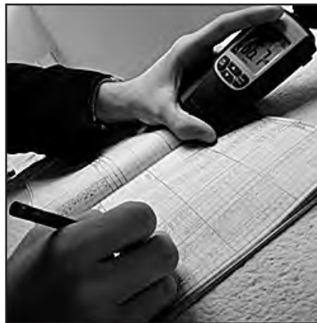
Captura de valors del nivell d'intensitat acústica en els canvis de classe
