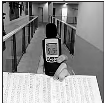
Mostres de nivell d'intensitat sonora en hores de classe, planta 1 de l'Institut Torredembarra
