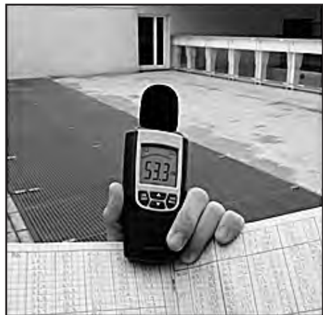
Mostres de nivell d'intensitat sonora en hores de classe, planta 3 de l'Institut Torredembarra
