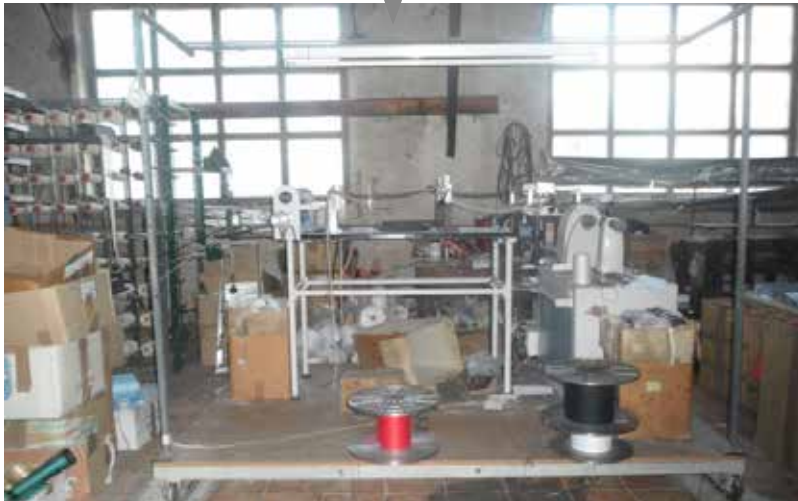
Els fils passen per l'ordidor per quedar enrotllats en el plegador. Arxiu familiar de la fàbrica.
