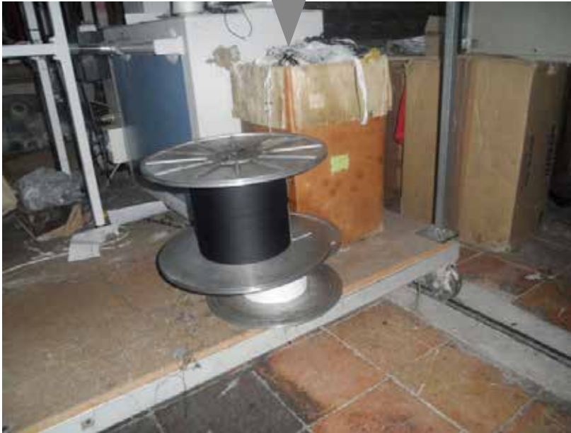
El fil una vegada ordit, enrotllat en el plegador. Arxiu familiar de la fàbrica.
