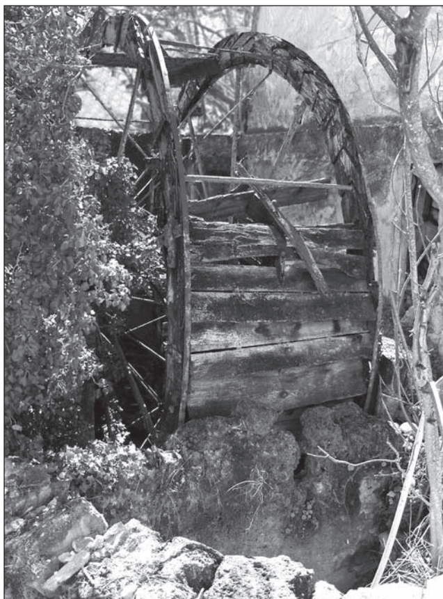
Lámina 7. Rueda hidráulica del Molino de San José (El Molinar), similar a la instalada en el molino del Dr. Albors. Foto archivo del autor.
