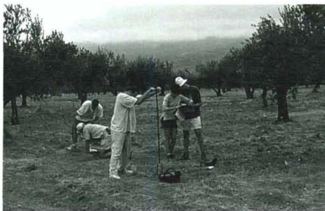
Foto 1. Práctica de un sondeo manual mediante la utilización de "augers".
