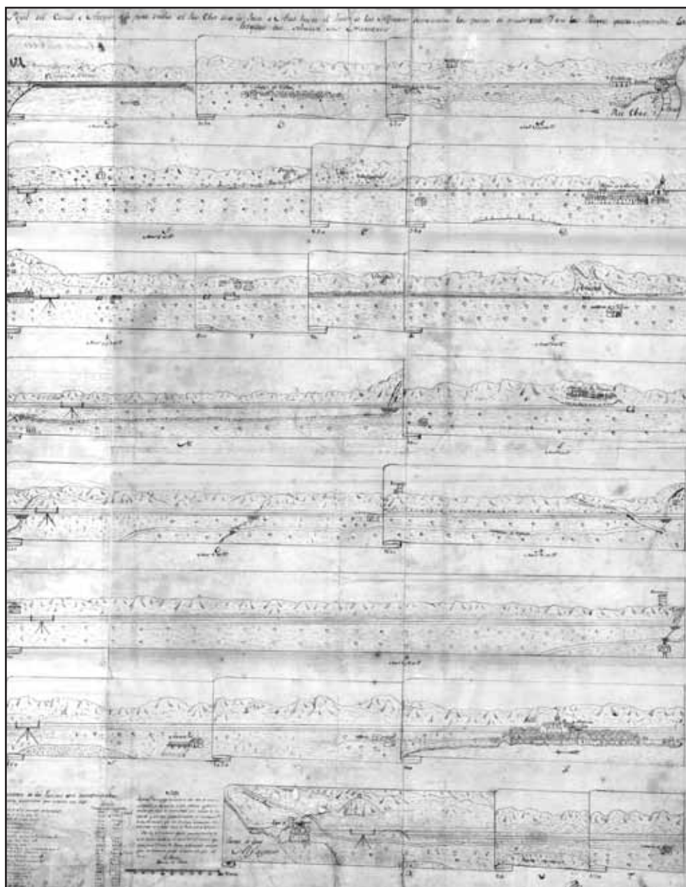
Secció del canal del marge esquerre, entre l'Assut i el port del Fangar
