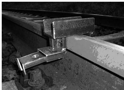
Mecanismo de bloqueo de la vía
