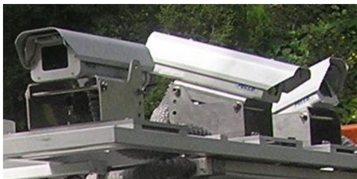
Figura 3: Conjunto cámara color y óptica (arriba). Soporte giratorio y carcasa protectora (debajo).
