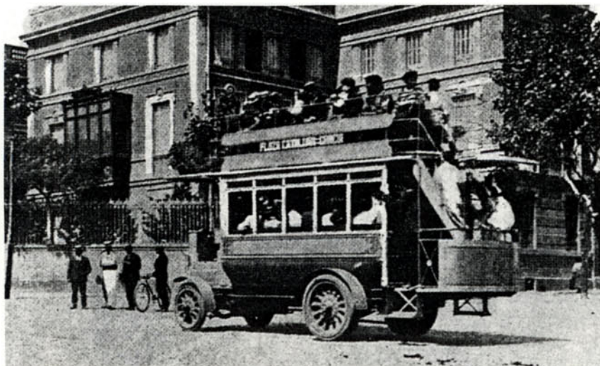
Foto 4: Autobús de La Catalana al Passeig de Gràcia. Observi's el doble accés de la plataforma posterior (Font: Boletín Informativo de TB, SA, SPM)
