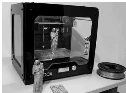
[Fig. 4] Impressora 3D d'extrusió i mostra d'impressions en plàstic de la Mare de Déu de Boixadors i un compartiment del retaule de Saulet.
