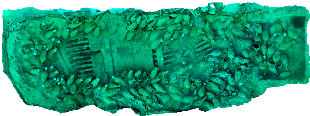
Figura 10. Ortofotografía por fotogrametría realizada, a partir de 1200 fotografías, en 2016 en el pecio Bou Ferrer (Vilajoyosa - Alicante) (imagen en Moya, 2017).
