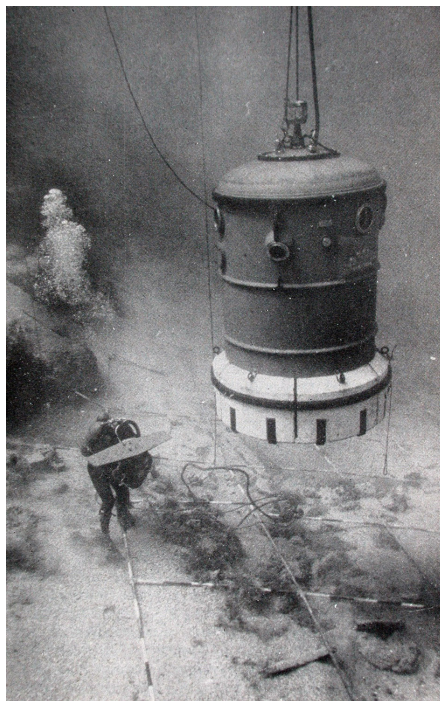
Figura 5. Pecio de Punta Scaletta. Campana batiscópica utilizada por Lamboglia para poder dirigir, desde debajo del agua, el trabajo de los buceadores (imagen en Gianfrotta y Pomey, 1981, pág. 79).
