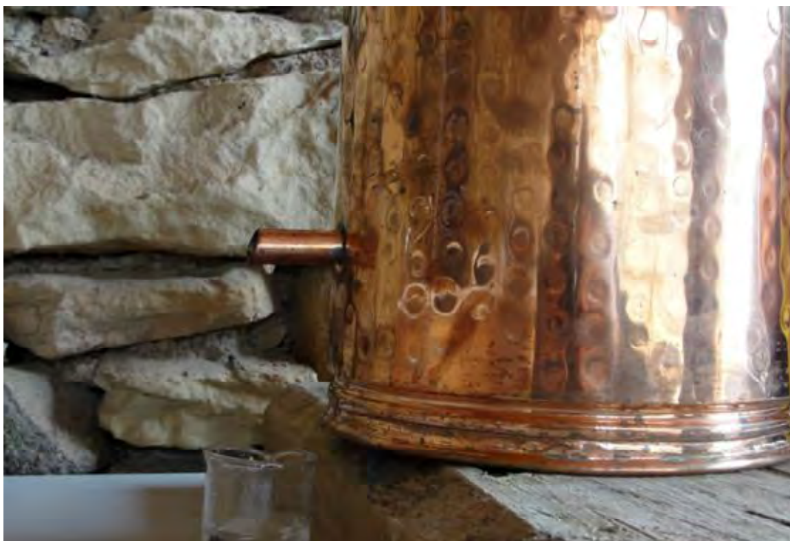
La destil·lació convé que vagi a poc a poc i el líquid caigui de gota en gota a fi i efecte d'evitar que no arrosseguem aigua de la mescla.
