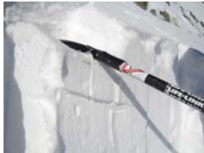
Exemple de test que no propaga. Observu la fractura iniciada sota la pala i que tira cap amunt pocs centímetres després de sortir de sota la fulla.
