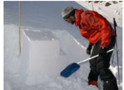
Un altre exemple de test negatiu, que no propaga. S'ha iniciat una fractura, però aquesta no ha travessat el bloc sencer.
