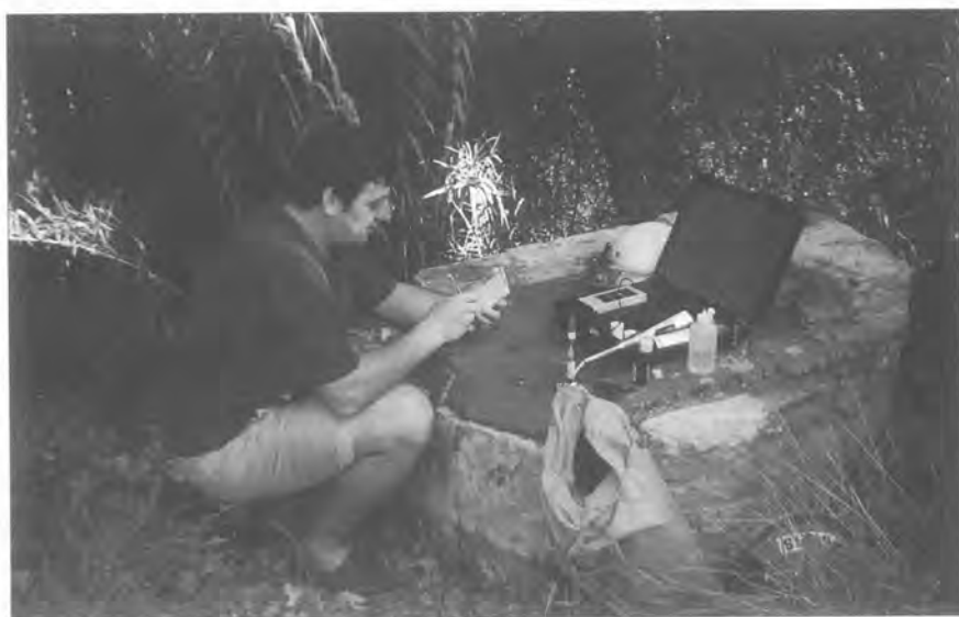
Mesura del pH en un dels accessos a la mina de Les Fatjones-Torreblanca.
