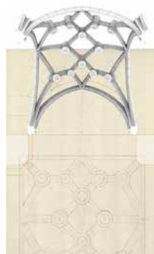
Figura 14. Volta ab dotsa claus.
