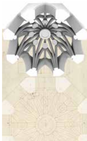
Figura 13. Volta buitavada ab nou claus.
