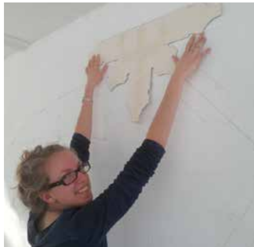
Figura 20. Una plantilla posicionada sobre la montea.
