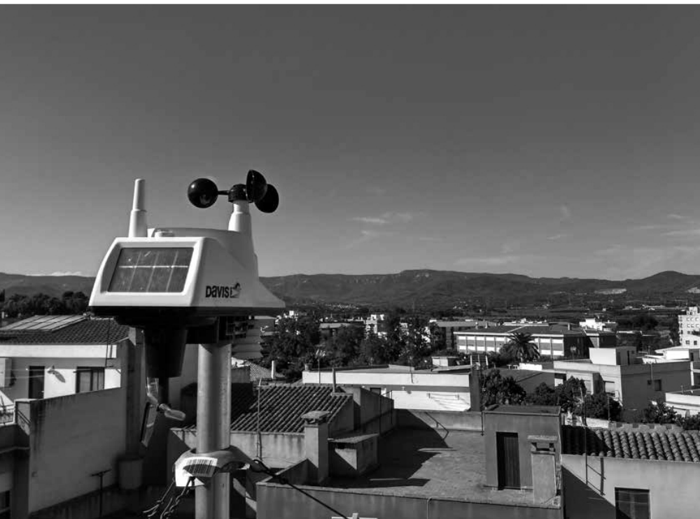
Imatge de l'estació meteorològica amb la qual us donem trimestralment els resums meteorològics de Riudoms. L'estació meteorològica en qüestió està instal·lada al centre del poble, lliure de qualsevol obstacle per tal de mesurar correctament la direcció i la velocitat del vent. Està formada per un anemòmetre (mesura la velocitat del vent), per un pluviòmetre (mesura la quantitat de pluja), per un termòmetre (mesura la temperatura), un higròmetre (mesura la humitat relativa de l'aire) i un penell (mesura la direcció del vent). També incorpora una placa solar que està encarada al sud per tal de proveir d'energia l'estació. Al fons de la imatge es pot veure la Mussara. Foto: David Agudé Vidal.
