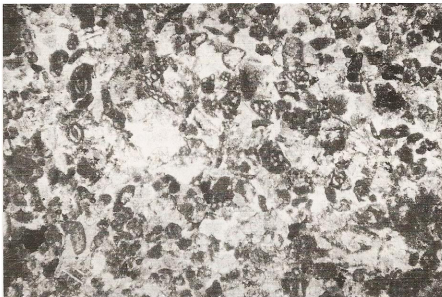
Figura 3. Mostra 043058. Calcària micrítica. Polaritzadors creuats. 60 augments.
