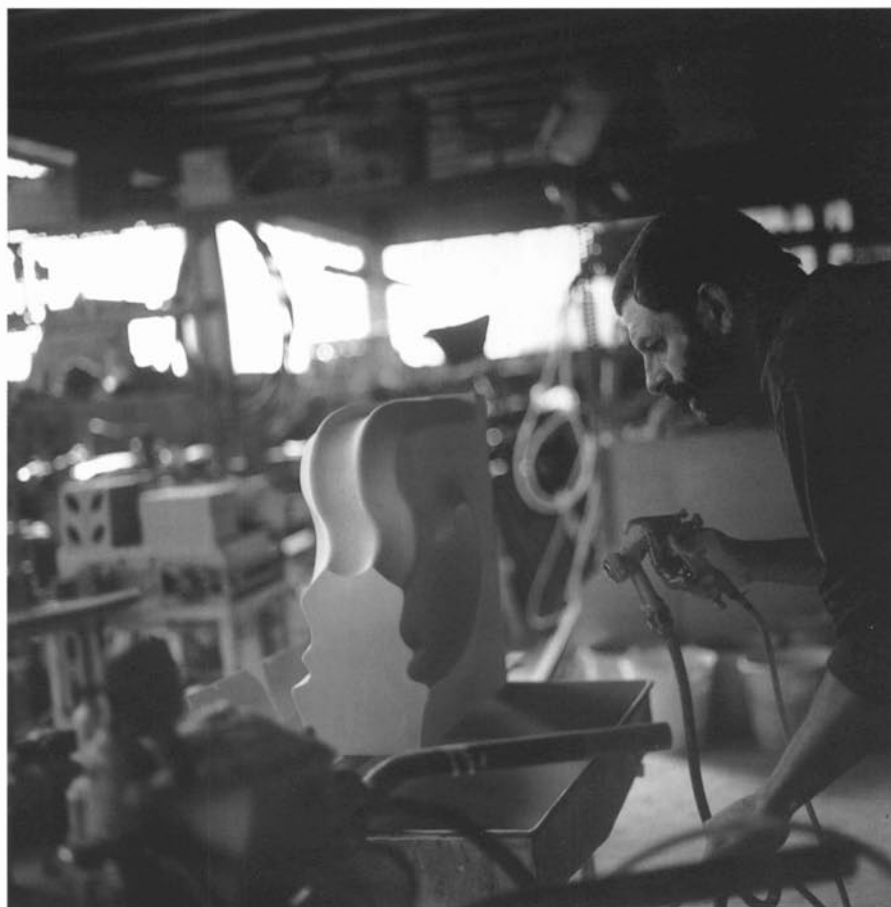
Toni Cumella esmaltant una peça de la Farinera Teixidor de Girona.
