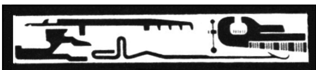
Platines i agulles de teler, símbols de la indústria del gènere de punt.
