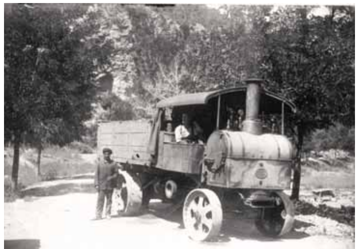
Un camió de vapor, marca Yorkshire, que segons el pare del senyor Eduard Pujals de la Pobla de Lillet era de l'Asland del Clot del Moro. Era de fabricació britànica, els van començar a fer el 1900, i fins ben entrats els anys 20, encara en feien. Servien pel petit transport. A la Gran Bretanya encara en queden molts en mans de col·leccionistes.
