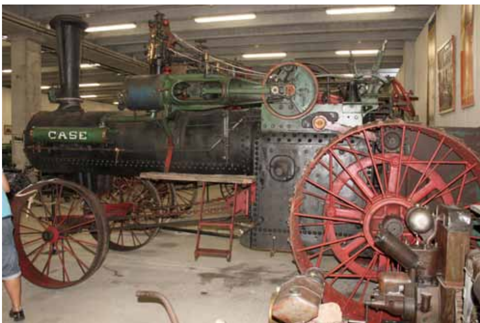
Locomòbil ianki, CASE, de 1910 de 60 HP. Pesa 6.700 kgs. En estat de funcionament..
