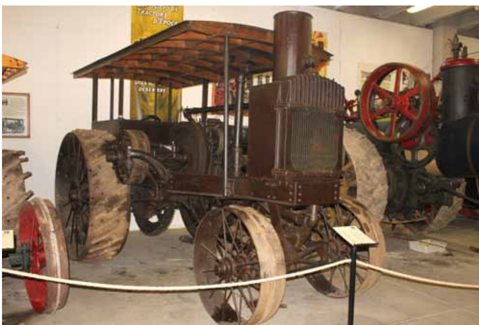
Un formidable tractor CASE de motor d'explosió amb benzina, de 1916, model «20-40 HP», bicilíndric en boxer de 14.730 cm 3 , que esta en funcionament.
