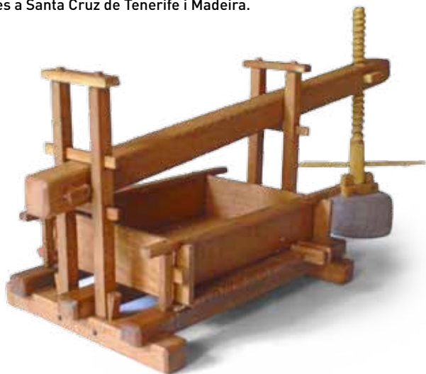
Fig.3.- Maqueta d'una premsa de biga amb el cup incorporat similar a les que es poden veure exposades a Santa Cruz de Tenerife i Madeira.
