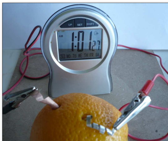
Fig. 1. Montaje del reloj que se acciona con una naranja.
