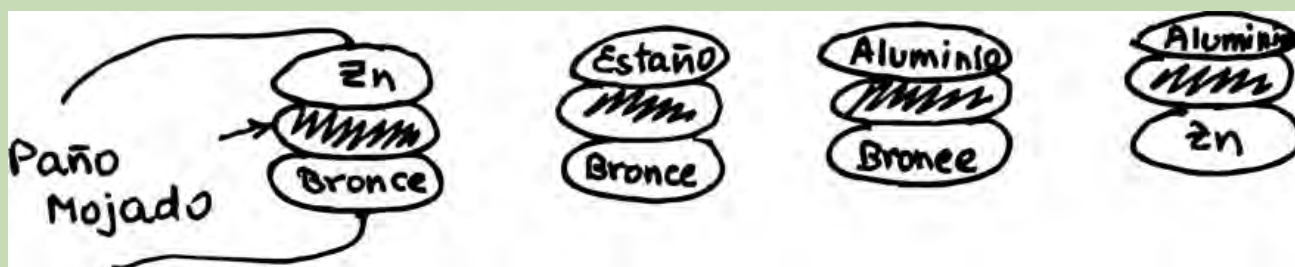
Figura 6. Apunts del quadern d'un professor la pregunta del qual feia referència a canviar el material dels discos i mesurar el voltatge generat.
