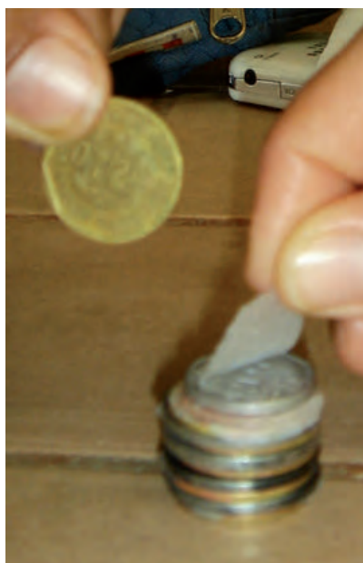
Figura 7. Construint la pila amb una pila de discos de monedes peruanes (10 i 20 cèntims) i paper humitejat en aigua amb sal.
