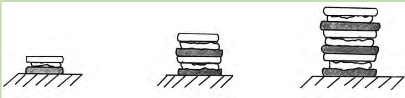
Figura 5. Apunts del quadern d'un professor la pregunta del qual feia referència a canviar el nombre de discos i mesurar el voltatge generat.
