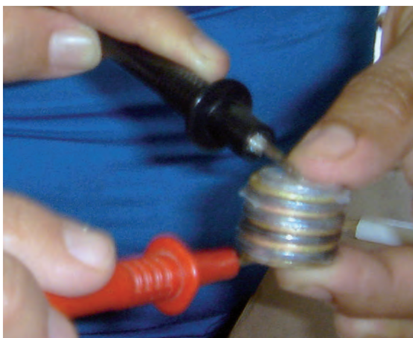
Figura 8. Mesurant el voltatge generat a la pila feta amb monedes peruanes (10 i 20 cèntims) i paper humitejat en aigua amb sal.
