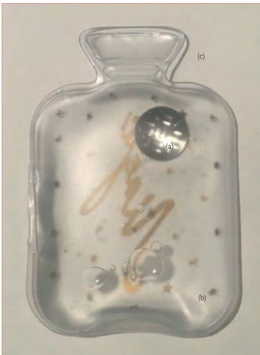
Figura 1. Escalfador de mans d'una solució d'acetat de sodi hipersaturada comprat a la ciutat de Kiel (Alemanya): (a) punt de nucleació, (b) solució saturada i (c) suport.
