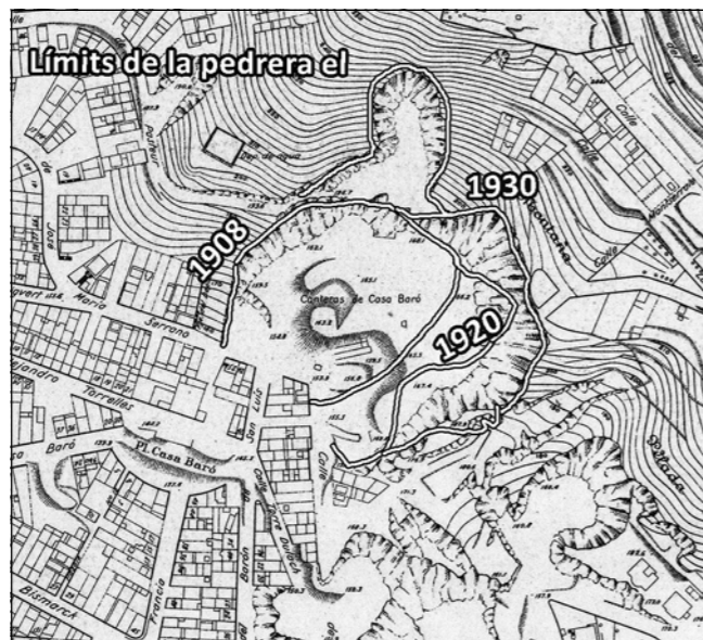
Avanç de l'esvoranc pels treballs de les pedreres
