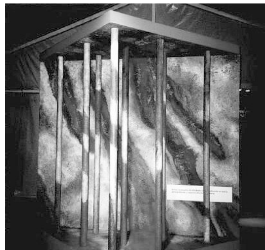
Figura 8. Caracterización de testigos de perforación atravesando en este caso un depósito de vetas.
